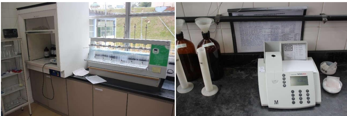
Figura 19: Laboratório para análises físico-químicas, destaque para aparelho de jar test e fotômetro, para análises de alumínio, ferro, manganês, cor e fluoreto.
